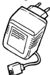
Nättransformator Anslutningskabel el-Nätuttag
